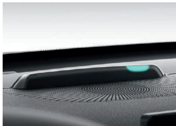
Indicateur de charge. Suivez votre état de charge avec l'indicateur de charge pratique. Situés dans la grille du haut-parleur au milieu du tableau de bord (et visibles même de l'extérieur de la voiture), les trois voyants LED de l'indicateur s'activent lorsque vous branchez le véhicule pour le recharger et vous tiennent informé(e) de l'état de charge et du niveau de la batterie.
